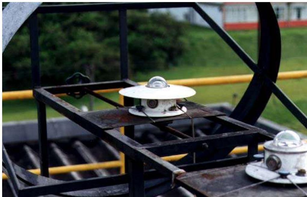
**Figura 4.1.4. Fotografia de dois piranômetros termelétricos [Oliveira, 1997].**
