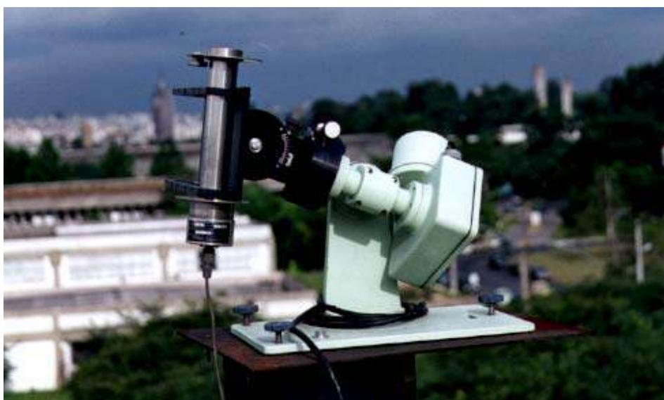
**Figura 4.1.5. Fotografia de um piroheliômetro [Oliveira, 1997].**
